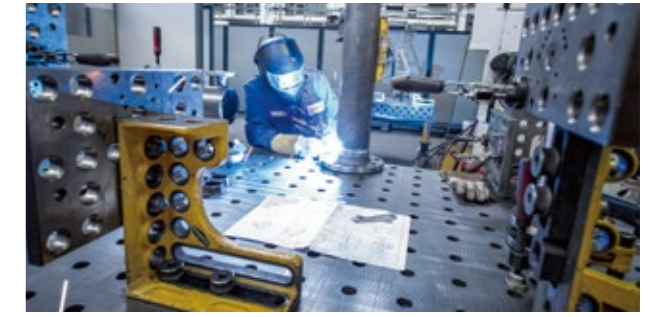
› Schweißen an Spezialvorrichtungen
